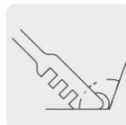
Ángulo de corte de 100° permite cortar vidrios de hasta 6 mm
